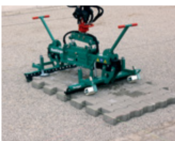
Szczęki do kostki z chwytakiem wielofunkcyjnym ułożą warstwę za warstwą.
